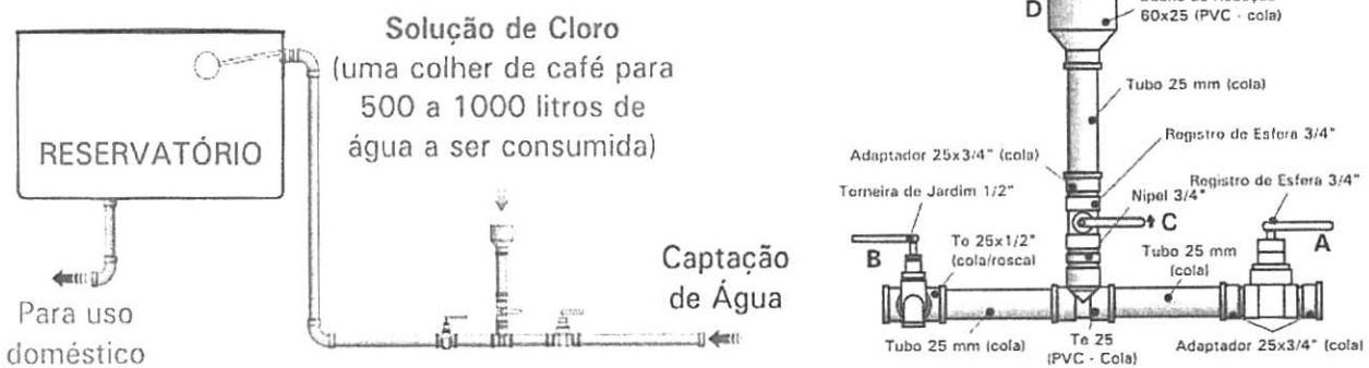
Figura 15 – Clorador Embrapa para o Saneamento Rural.
